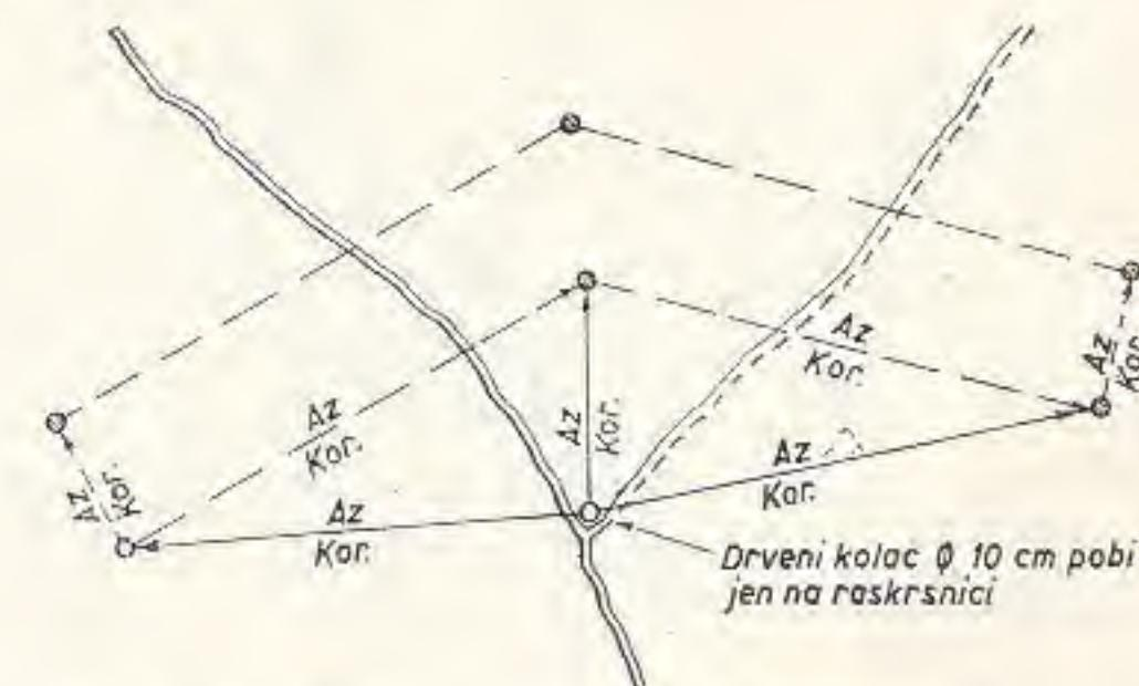
Sl. 1 — Način vezivanja minsko-eksplozivne prepreke (minskog polja) za orientire na zemljištu
